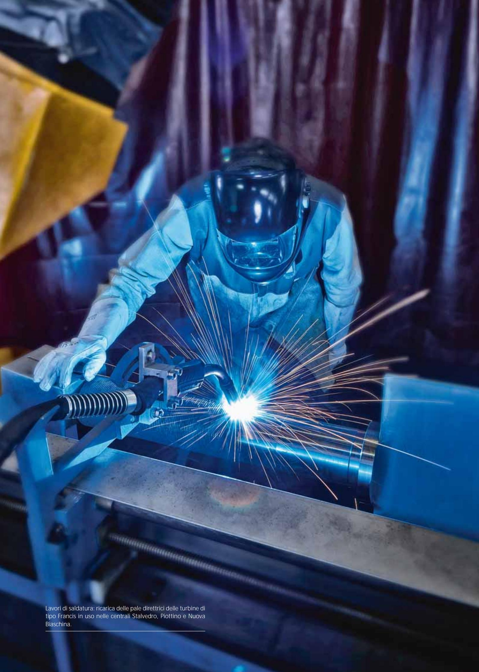
Lavori di saldatura: ricarica delle pale direttrici delle turbine di tipo Francis in uso nelle centrali Stalvedro, Piottino e Nuova Biaschina.
