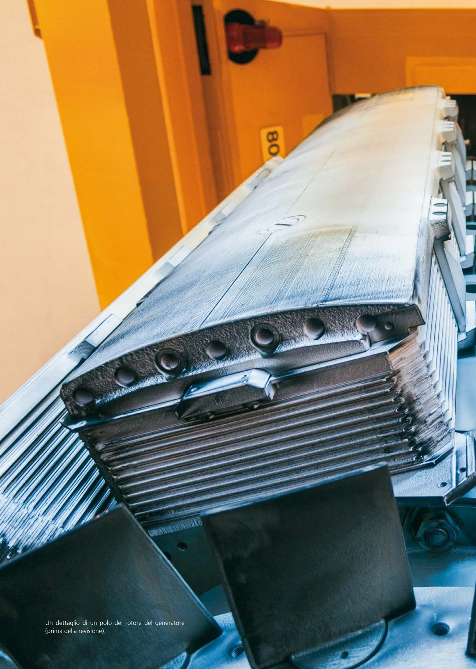
Un dettaglio di un polo del rotore del generatore (prima della revisione).
