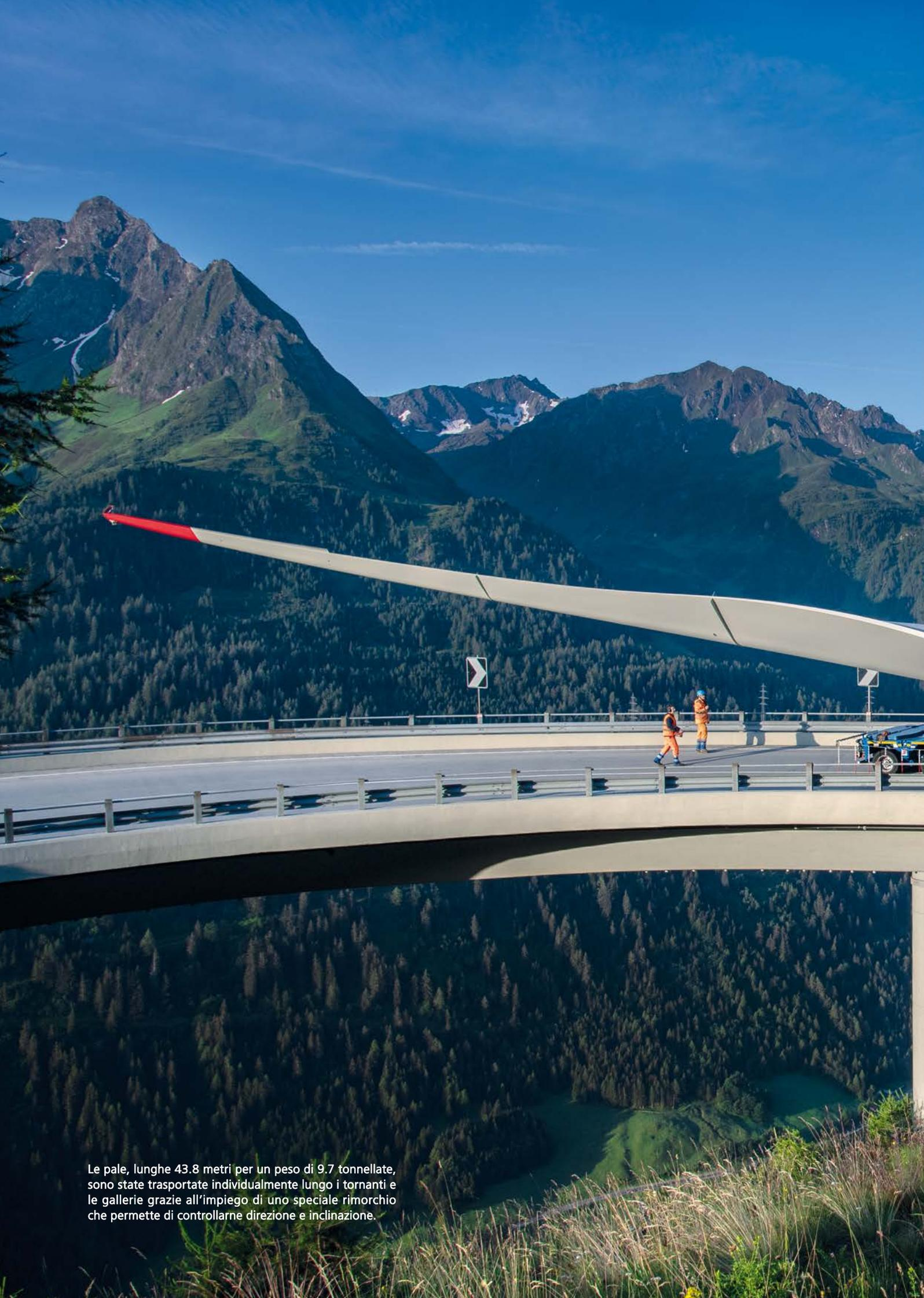
Le pale, lunghe 43.8 metri per un peso di 9.7 tonnellate, sono state trasportate individualmente lungo i tornanti e le gallerie grazie all'impiego di uno speciale rimorchio che permette di controllarne direzione e inclinazione.
